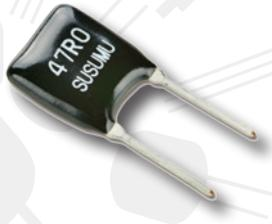
Der neue Ultrapräzisionswiderstand **LRG020** vom Technologieführer Susumu mit einer Widerstandstoleranz von  $\pm 0.01\%$  und einem Temperaturkoeffizienten von  $2 \text{ ppm}/^\circ\text{C}$  zeichnet sich durch unübertroffene Zuverlässigkeit und ausgezeichnete Stabilität bei unterschiedlichen Umgebungsbedingungen aus. Rauscharm, da NiCr-Bauweise, bleifrei und RoHS konform sind weitere Qualitäten.
