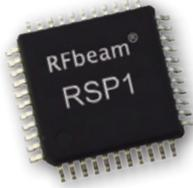
**RSP1** ist das erste Mitglied der neuen RFbeam Radar Signal Prozessor Familie. Dieser Baustein enthält das gesamte Know-How für die Auswertung der Doppler-Radarsignale. Mit diesem Controller lässt sich ein Geschwindigkeitsbereich von ca 1 km/h bis ca 200 km/h abdecken.
