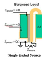
Die isolierende Wirkung der Balun-Struktur im Zusammenspiel mit dem hochwertigen Design der Antenne bietet eine ausgezeichnete Performance. Die Verwendung von unterschiedlichen dielektrischen Materialien konzentriert die Resonanzfelder in den dielektrischen Kern und erzeugt ein ausgezeichnetes Strahlungsmuster, auch dann, wenn die Antenne im Gerät integriert ist und Bauteile wie LCD, Schalter, Stecker etc. in unmittelbarer Nähe bestückt sind.
