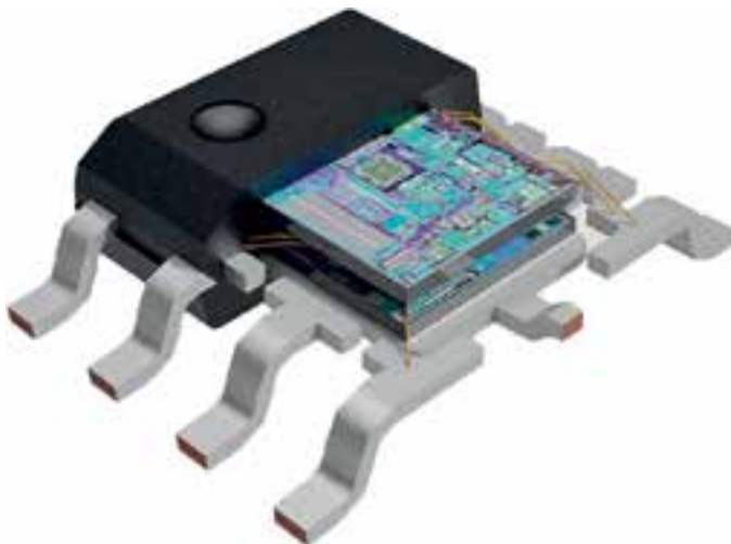
4 | Redundanz: In einem SOIC8-Gehäuse befinden sich zwei identische, aufeinander gestapelte Halbleiterchips, die gegeneinander um 180° verdreht sind. Dadurch können die Anschlüsse der zwei Chips jeweils auf den gegenüberliegenden Seiten des Gehäuses herausgeführt werden
